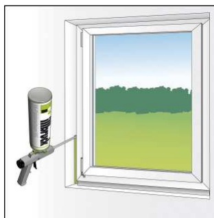
Ilustracja 3: Wypełnić pianką fugę okienną
